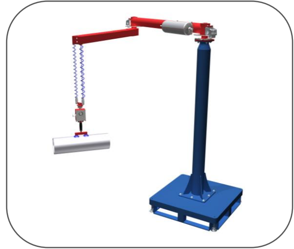
Knickarm mit mobiler Bodenplatte verfahrbar mit Gabelstapler oder Hubwagen
